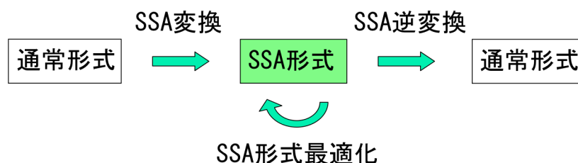
図 5 SSA 形式を用いた最適化の流れ
